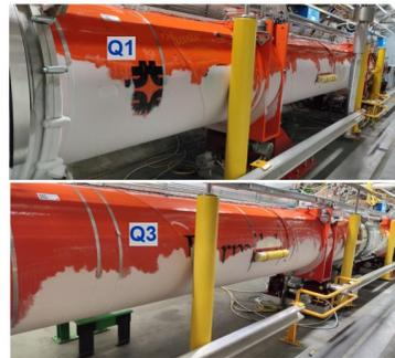
7月份LHC超导磁铁液氮泄露
