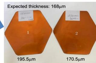
钨铜合金底板: 已经生产了75块, 将为高能所硅模块中心提供所需钨铜合金底板, 正在进行辐照测试
