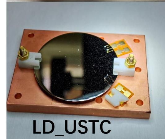
Orsay\_2018光探测器, 固定在MC冷盘上
