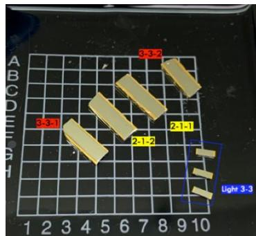
性能测试: I-V, R-T 曲线:  $R > 10 \text{ M}\Omega @ T < 20 \text{ mK}$
