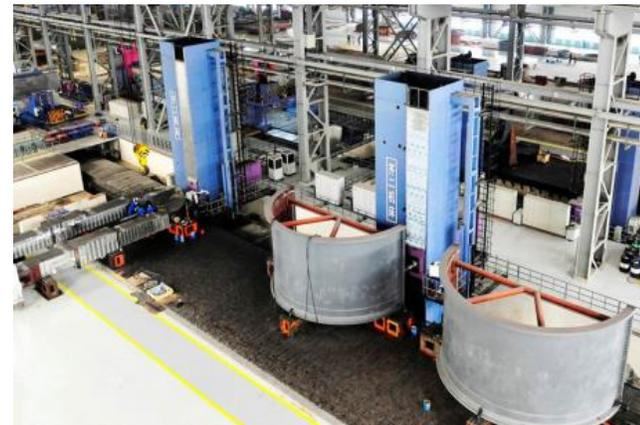
齐二机 $\phi 320\text{mm}$ 数控镗铣床
