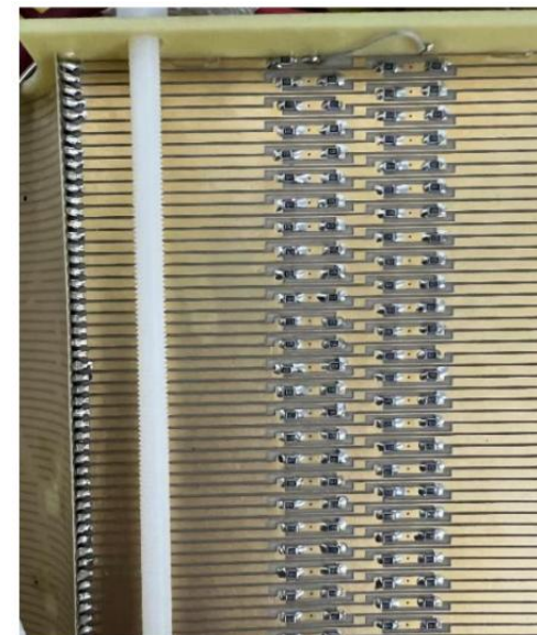
内外场笼及电阻串焊接
