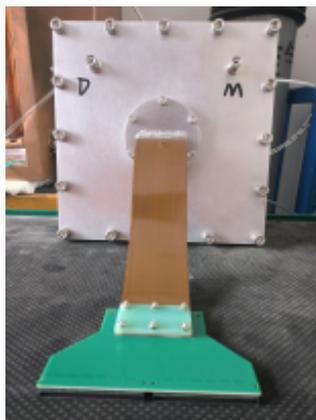
**轻便型：**简单调试使用，优点是使用螺纹和垫圈密封，便于拆装
