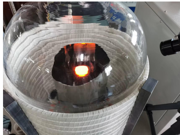
购置新的阴极除气台电子枪 预除气及温度曲线测量
