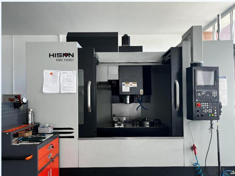
高精度四轴加工中心，加工高精度零部件
