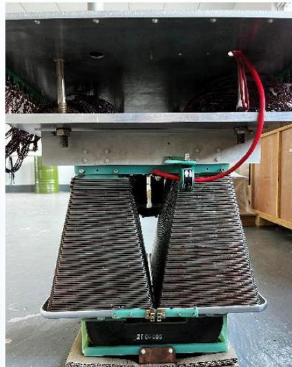
3: 从油缸顶盖至脉冲变压器的引线采用我公司特殊的线缆设计工艺使得放电单元等效引线分布电感控制在10nH以下
