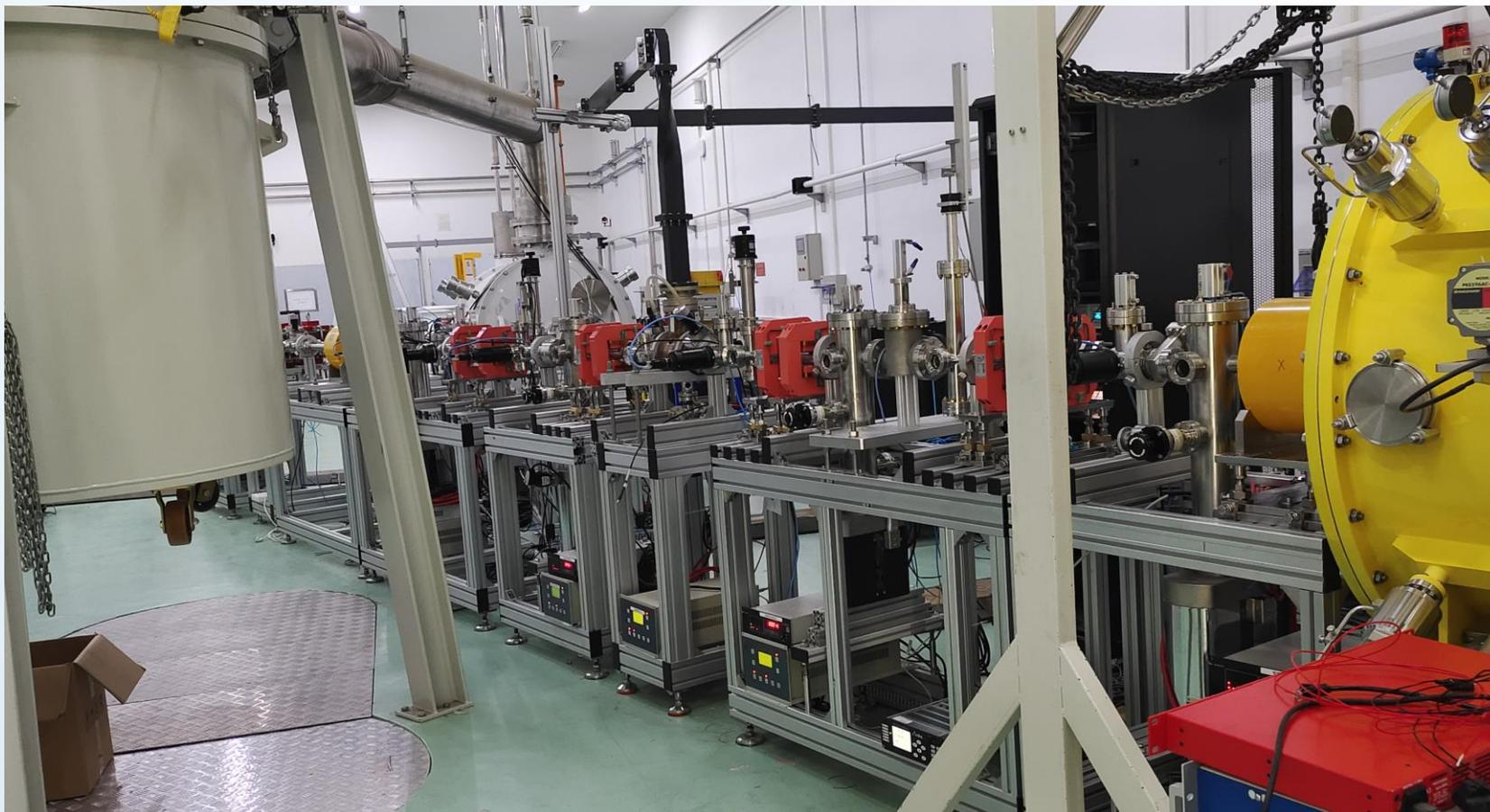
我公司提供的北京大学超导射频实验室FEL束线（磁铁，支撑结构，真空室，波纹管等）
