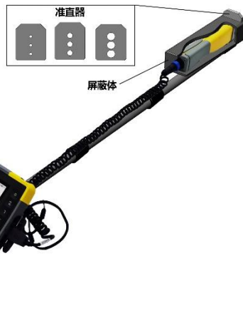
RayMon10® 迄今世界上在探测、测量、 识别和分析放射性核素领域 中分辨率最高的CZT手持探 测器
