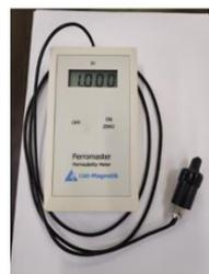
★磁导率测量仪
