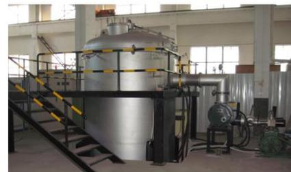
☆φ1600长2500mm真空氢气两用钎焊炉
