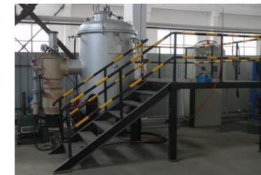
☆φ750长3000mm真空氢气两用钎焊炉
