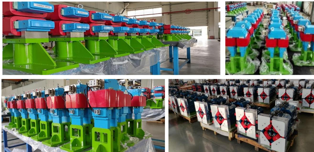
偏转磁铁 四极磁铁 六极磁铁 校正磁铁 支架
