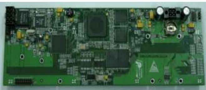
声信号处理与定位解算电路
