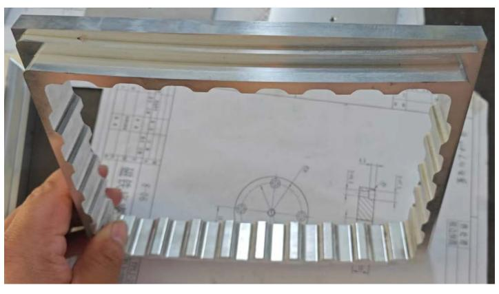
材料: 6061-T651, 无磁高强度铝合金材料 技术要求:
