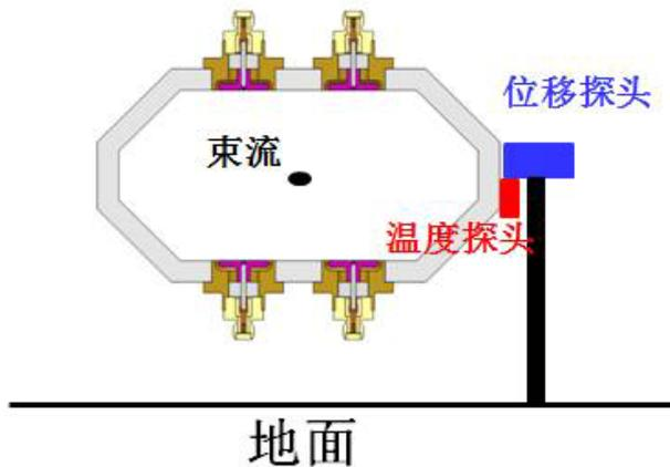
分布式光纤监测恒温器变形 (FCC)
