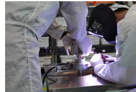
电子枪阴极及聚焦极焊接
