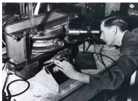
图 22: Kerst 和他发明的第一台 Betatron
