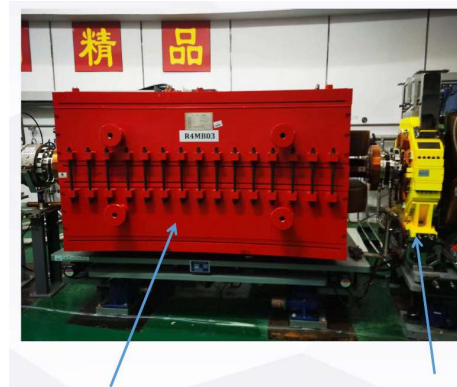
图 48: 二极磁铁和六极磁铁
