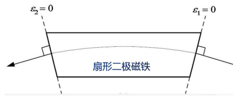
图 64: 垂直入射二极磁铁。
