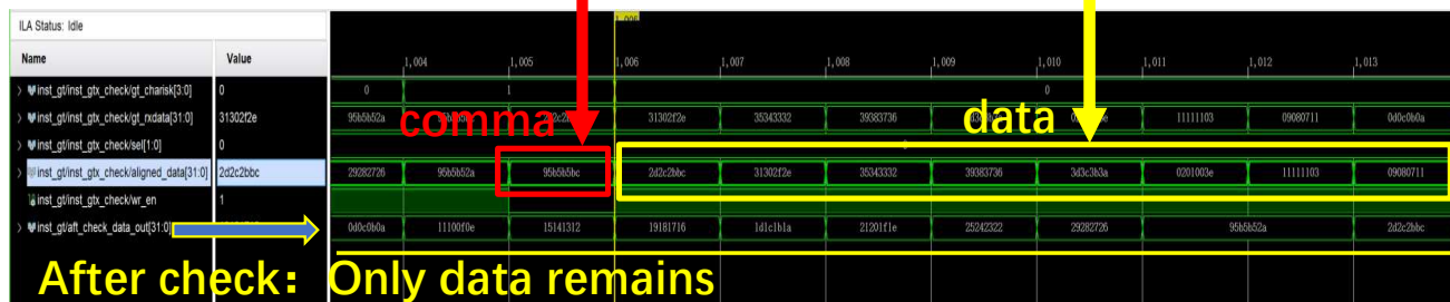
FIG 2. MFT v1.1 数据自收发增加筛选功能后测试结果
