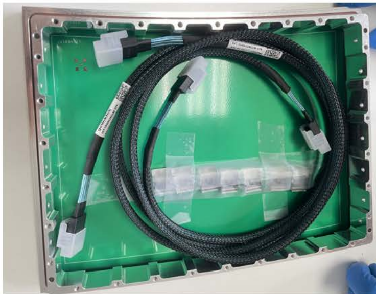
1.2T磁场内连接线缆的模块测试
