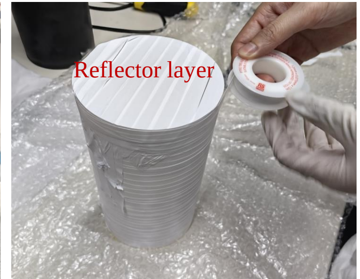
Reflector layer wrapping
