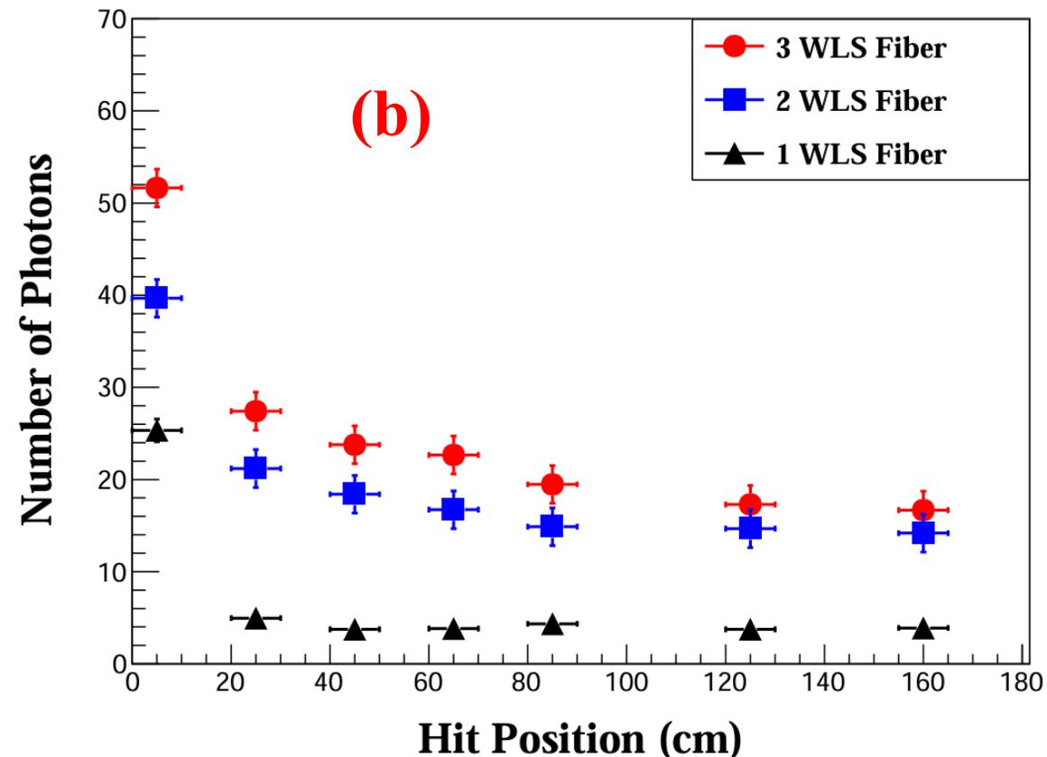
为了排除图(a)中的差别来源于塑闪内壁透光程度带来的影响，对塑闪#1逐步增加光纤进行测试，结果如图(b)。
