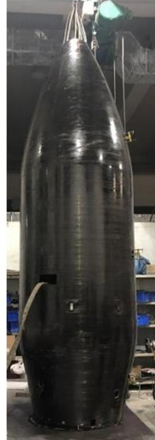
**工艺：** ECAL主结构，网格结构工艺实现没问题，网格精度可控制在0.1mm量级。
