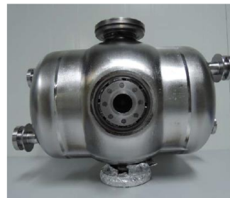
325 MHz HWR cavity (beta 0.14)
