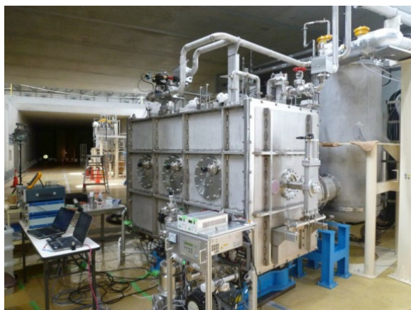
cERL 1.3 GHz Injector Cryomodule
