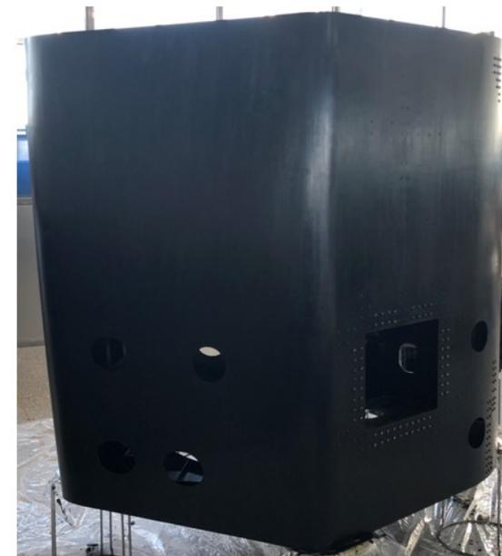
主承力复材舱段主要由后舱、发动机及气瓶安装结构、底端支撑接口结构、起吊支撑结构组成。其中后舱为复杂截面型材框架、蒙皮结构异性结构，
