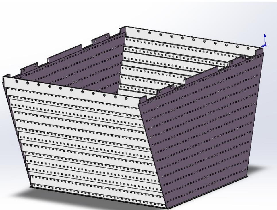
下底面2mm、侧壁1mm、顶盖2mm
