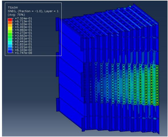
模块整体最大变形从0.13-0.8mm，此为27层累积变形，结合晶体弯曲变形分析，认为模块结构足以保护晶体不被损坏。
