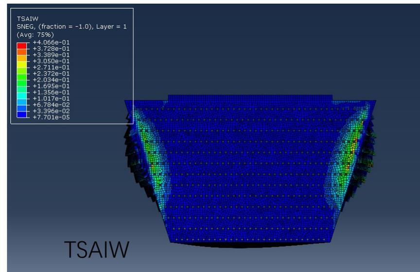
外壳应力及TSAIWU值均满足要求，变形量3.5mm，超出晶体可承受范围。下一步换高模量碳纤维进行计算。
