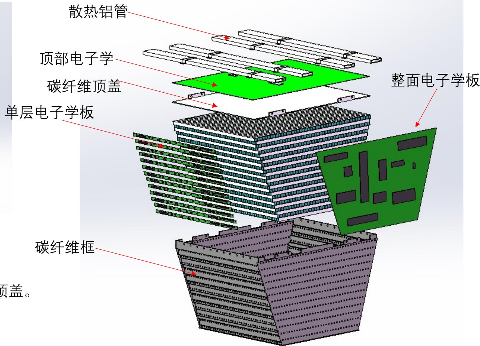
优化后的框架保留下底面和侧面，顶部加顶盖。
