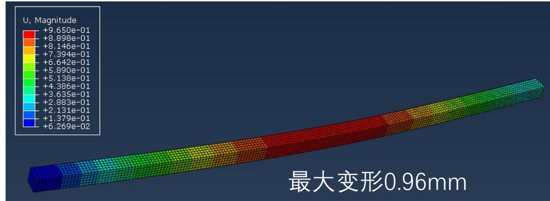
通过模拟，尺寸为10\*10\*400mm的BGO晶体条，弯曲应力约30MPa时，最大变形0.96mm。以此作为模块保护壳设计依据。
