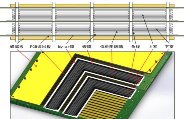
图 10 eTOF MRPC 结构示意图。
