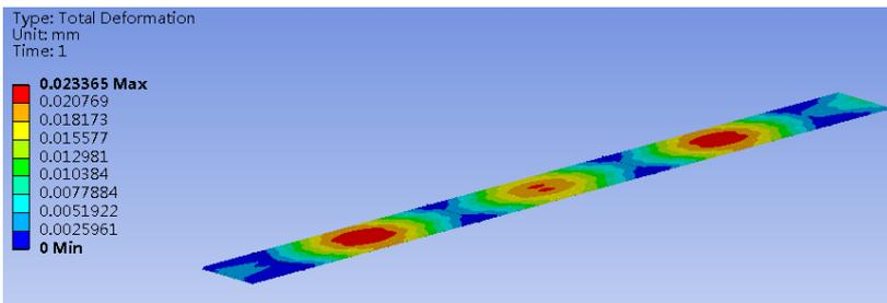
stave支撑结构加载均布质量（2.6 kg）最大变形 0.22mm
