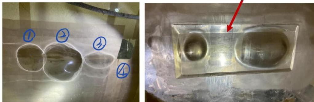
有机玻璃球裂缝模拟研究(IHEP & SJTU)
