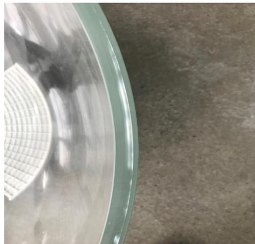
水压实验后端面有裂痕
