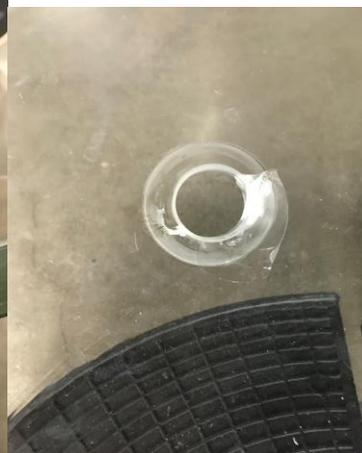
水压实验后孔有裂痕
