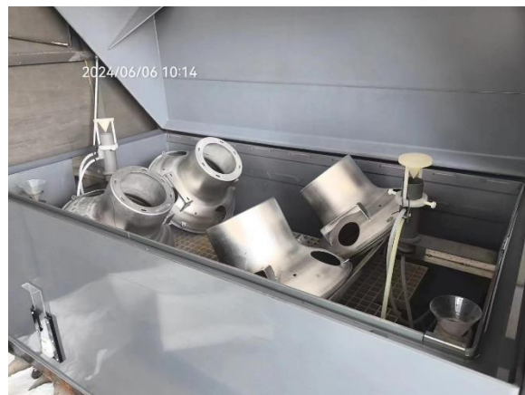
不锈钢保护罩盐雾试验
