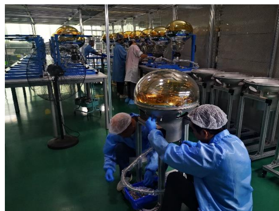
保护罩与PMT进行组装
