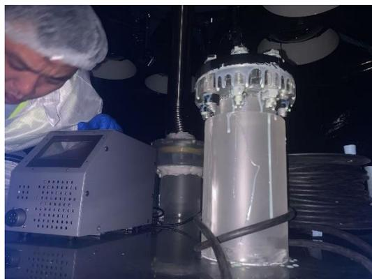
所有法兰缝隙涂环氧胶
