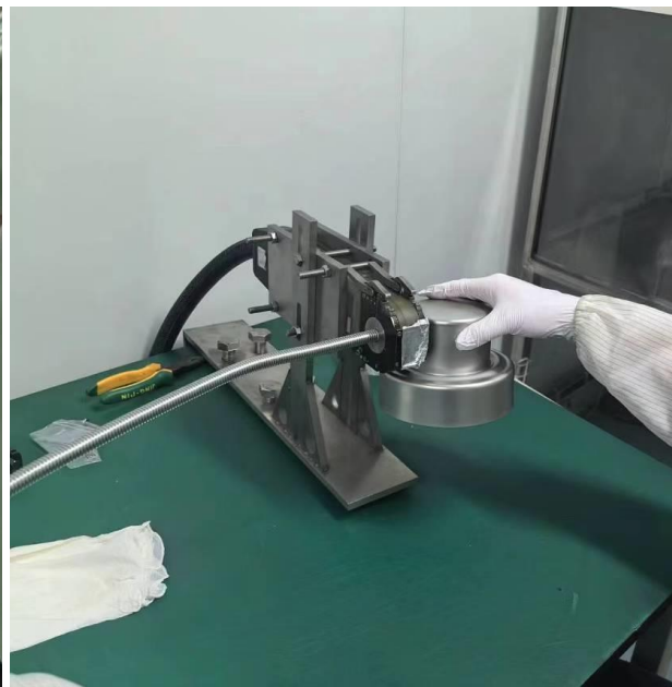
Potting壳与波纹管焊接
