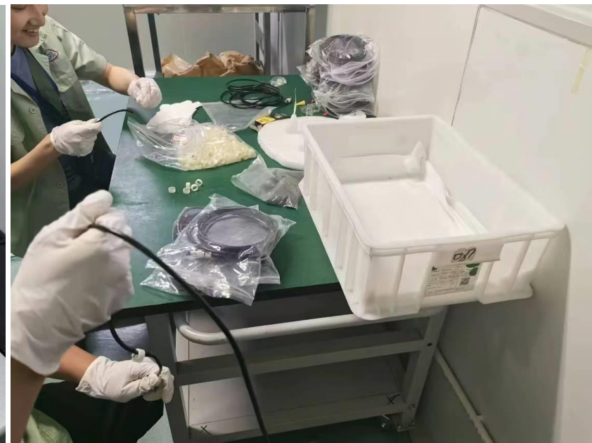
SHV接头在波纹管内穿线
