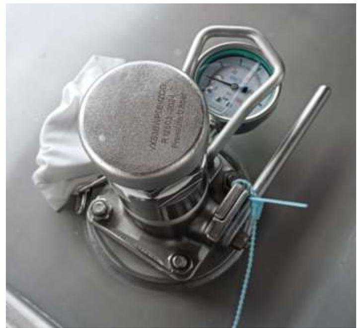
装货前，罐顶气阀安装泄压阀
