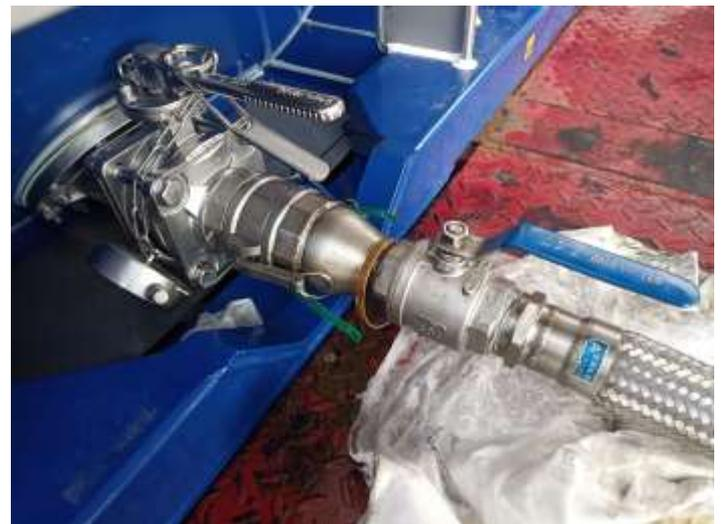
底阀通过转接头接装车软管
