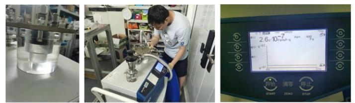
7.15日常温密封测试, 氦检漏喷
