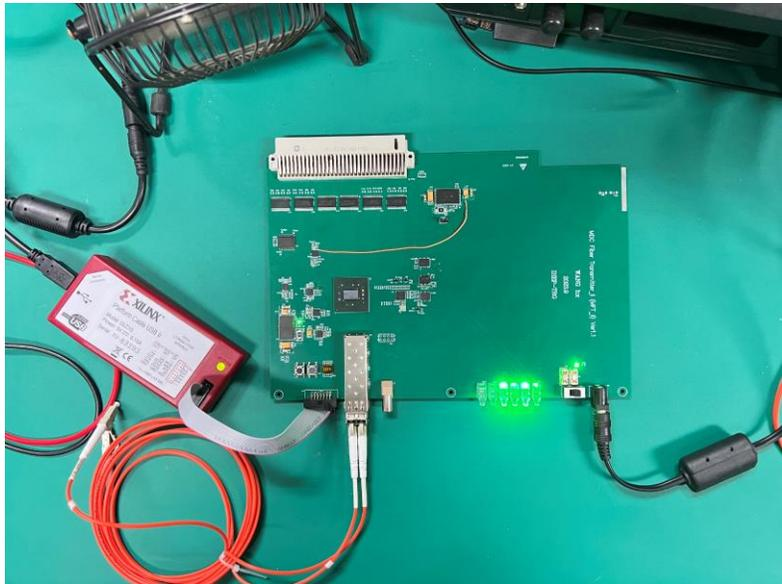
MTB板对应关系测试/触发核心板VME端口测试环境
