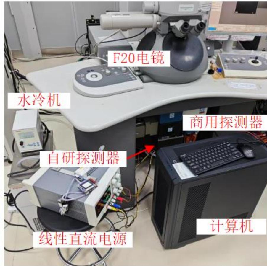
安装在F20电镜上的原型相机系统
