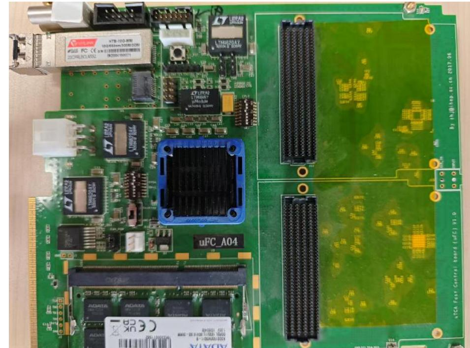
SSDROC本身的驱动时序已经确定，在通过用户数据报协议（UDP）从DAQ接收配置参数后，测试系统并行控制SSDROC，串行数据通过FPGA的串并转换模块、乒乓操作模块和数据拼接模块转换成并行数据流。FIFO用于模块间的数据交换，完成数据位宽的转换和跨时钟域的处理。
