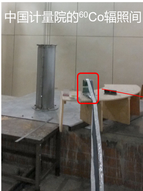
辐照测试接口电路
