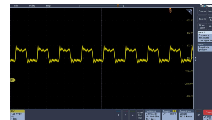
图17. 光纤收发器接收端LVPECL波形图
