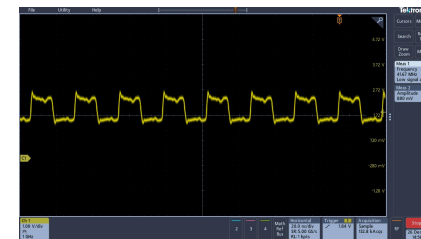
图16. LVDS输出P端波形图
