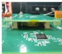
子板安装在测试转接板上
