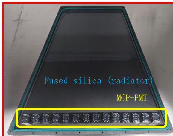
DTOF 1/3尺寸样机(辐射体, MCP-PMT, 电子学、机械) 4.4\sigma 的 \pi/p 分辨@4GeV/c
