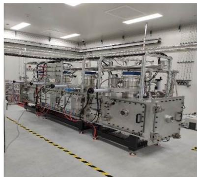
X射线镀膜工艺研究平台：镀膜机/XRD/原子力显微镜等
