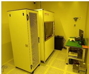
微纳加工实验室间-光刻间（300nm光刻机，高精度显微镜）
