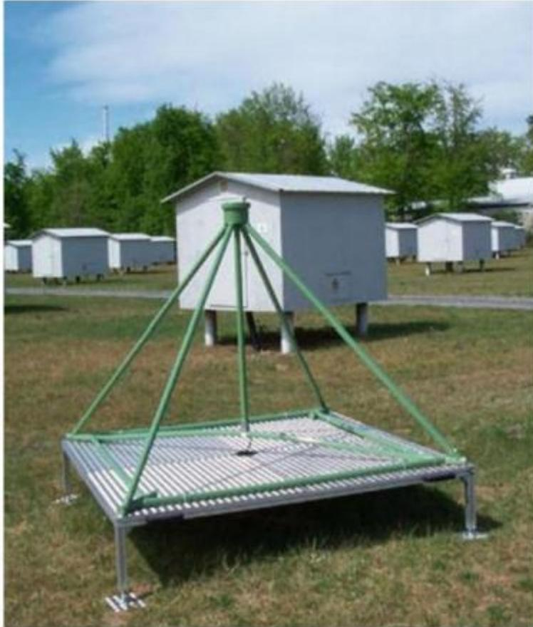
图 7.39 KASCADE-Grande 空气簇射探测器中 LOPES 实验的反向偶极子天线。背景中可见几个测量站，用于触发无线电信号的读出 [137]。
