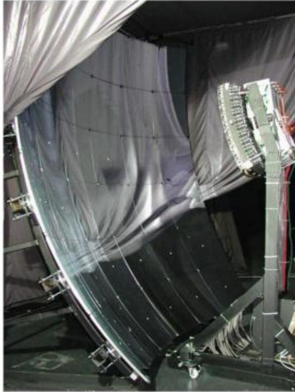
图 7.32 用于测量俄歇实验中荧光辐射的探测器的镜子和照相机的照片[129]
