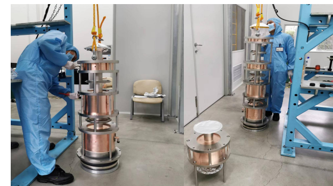
整管总装，使用了全新的结构，提高了装配精度也大大缩减了装配时间和装配人员数量
