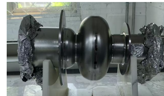
HALF 1Cell 椭圆腔 (1500MHz)
