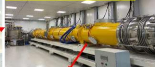
1300MHz 9Cell cryomodule
