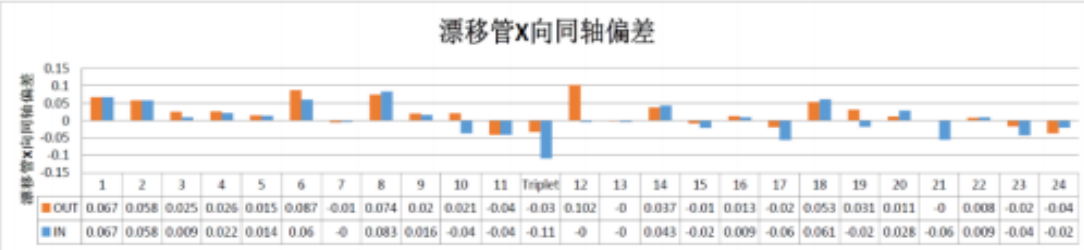
图3 漂移管 X 向同轴偏差
