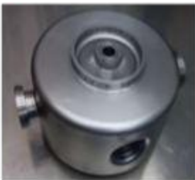
Spoke 021 ADS 主加速器超导腔 小批量生产
