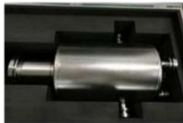
HEPS-TF超导腔 第一支QWR超导腔 (166.7MHz)
