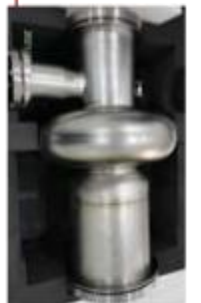
Cavity HLS 超导腔 (500MHz)
