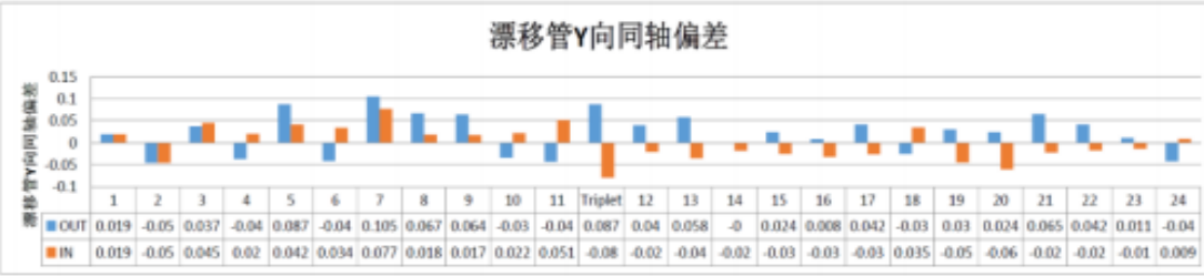
图4 漂移管 Y 向同轴偏差
