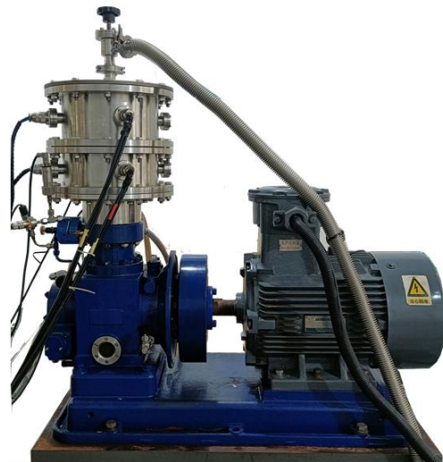
制冷量: 50 W @ 20 K, 138 W @ 30 K 单缸两级斯特林低温制冷机
