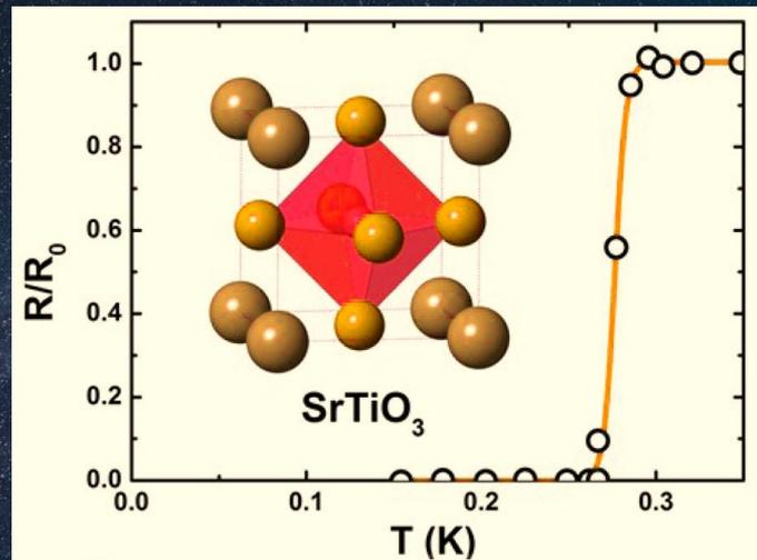
1964年， $\text{SrTiO}_3$ 成为第一个被发现的氧化物超导体， $T_c = 0.3 \text{ K}$ 。
