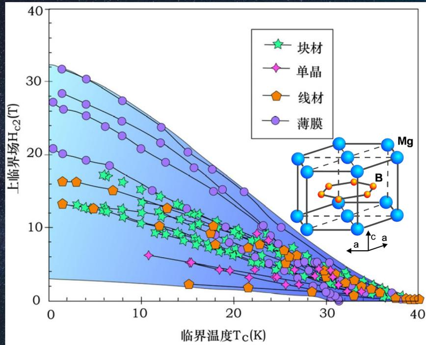
2001年发现的 $MgB_2$ 超导体无论掺杂、加压、块材、单晶、薄膜， $T_c$ 都无法超越40 K。
