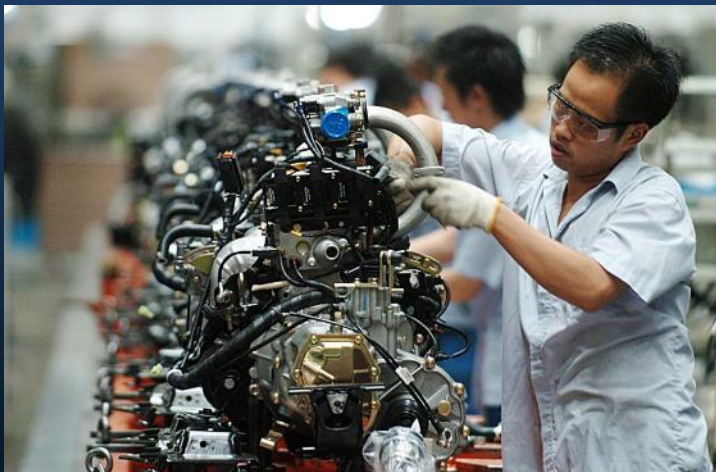
2005年的发动机生产线，重度依赖人力操作
