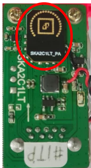
定制的单通道毫米波收发模组
