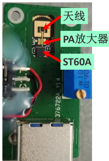
定制的单通道毫米波收发模组
