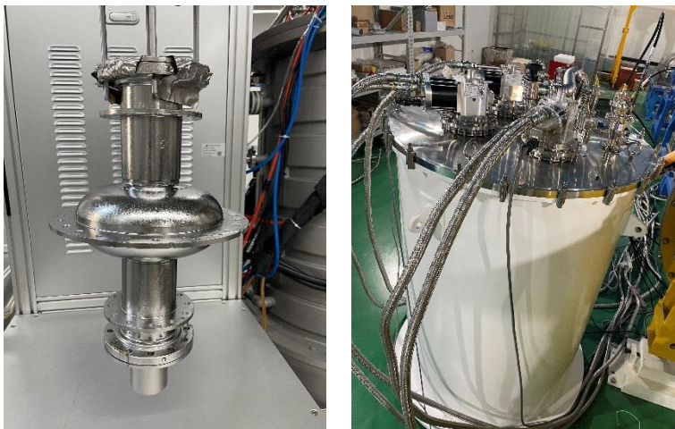
铌三锡镀膜超导腔的传导冷却测试
