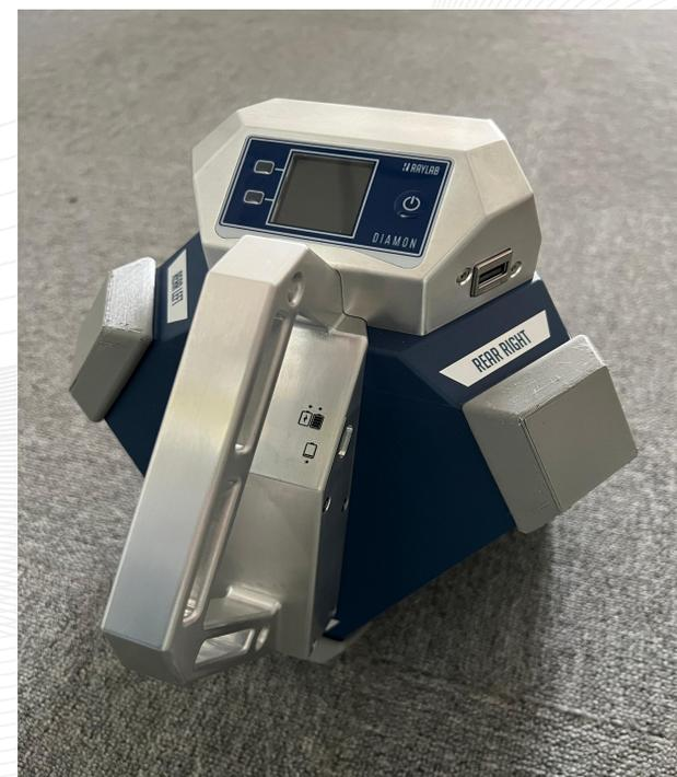
图8 DIAMON中子谱仪实物图
