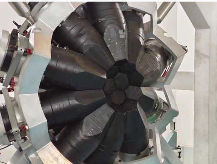
·GTAF装置由40个探测单元组成，其中包含12块五棱锥台形晶体和28块六棱锥台形晶体。该探测器能够覆盖**95.2%的立体角**。对**50 keV到9 MeV**的探测效率可以达到**85%以上**。
