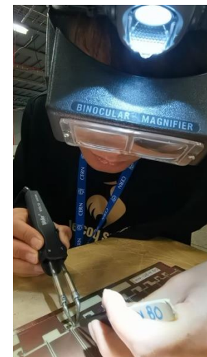
完成96块PCB板的铜皮包装和电阻焊接工作，共焊接电阻20736个
