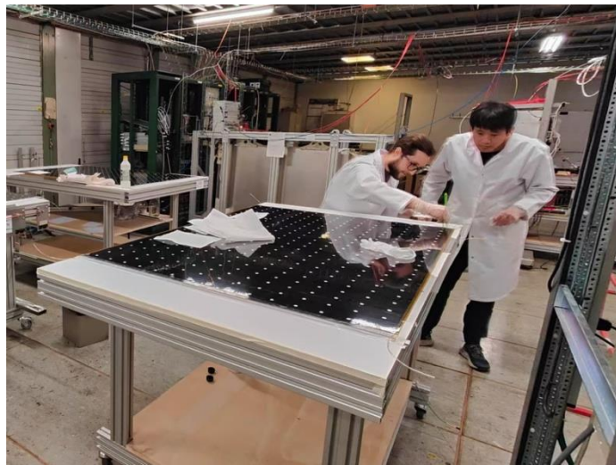
完成气室补胶24块并进行气密性测试
