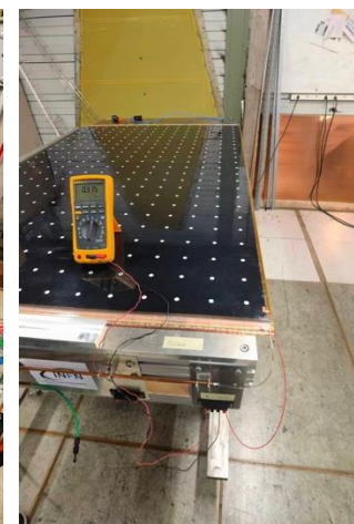
完成96块PCB板的铜皮包装和电阻焊接工作，共焊接电阻20736个
